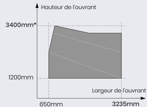
\* Les dimensions maximales dépendent de la charge du vent et de la structure du montant central
